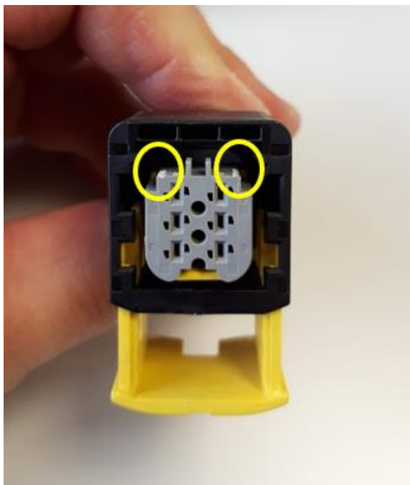
Abbildung 16 – Modifizierter Stecker für NO x -Sensor
