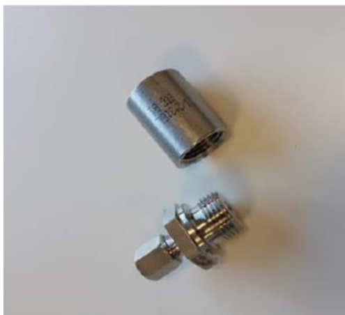
Abbildung 14 - Einschweißmuffe und Verschraubung vom Thermoelement
